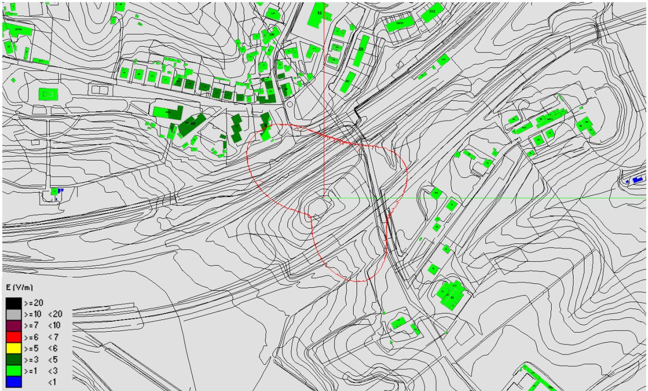
Fig. 38 Impatto Elettromagnetico – zona Via San Gervasio Loc. La Rotta – Vista dall'alto senza solido
